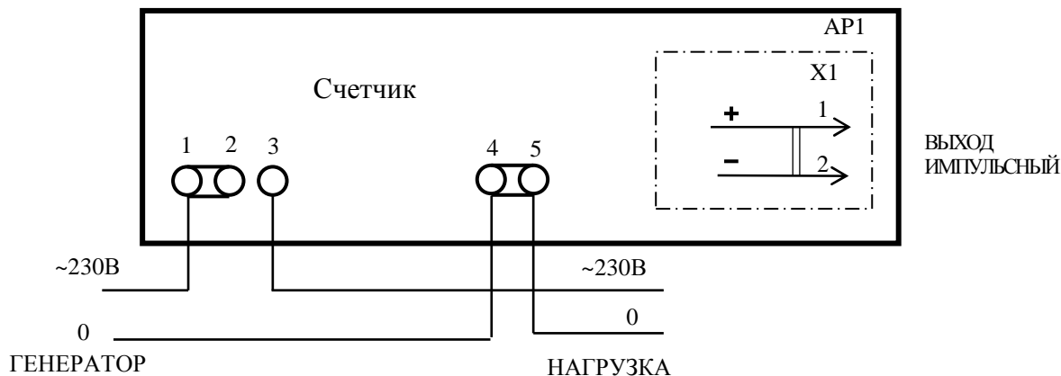
Рисунок Б.1 – Схема подключения счетчиков СЭО-1.09.302, СЭО-1.09.302/1
