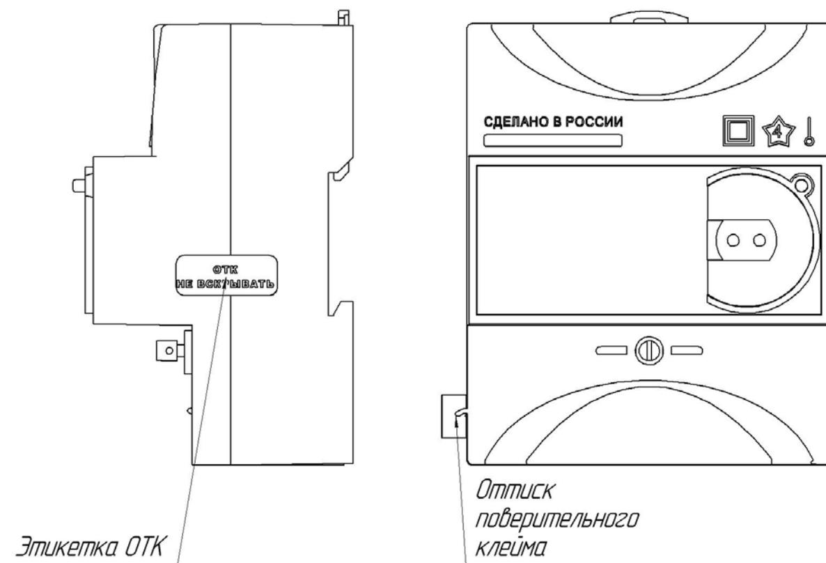
Рисунок 2 – Схема пломбирования счётчика
