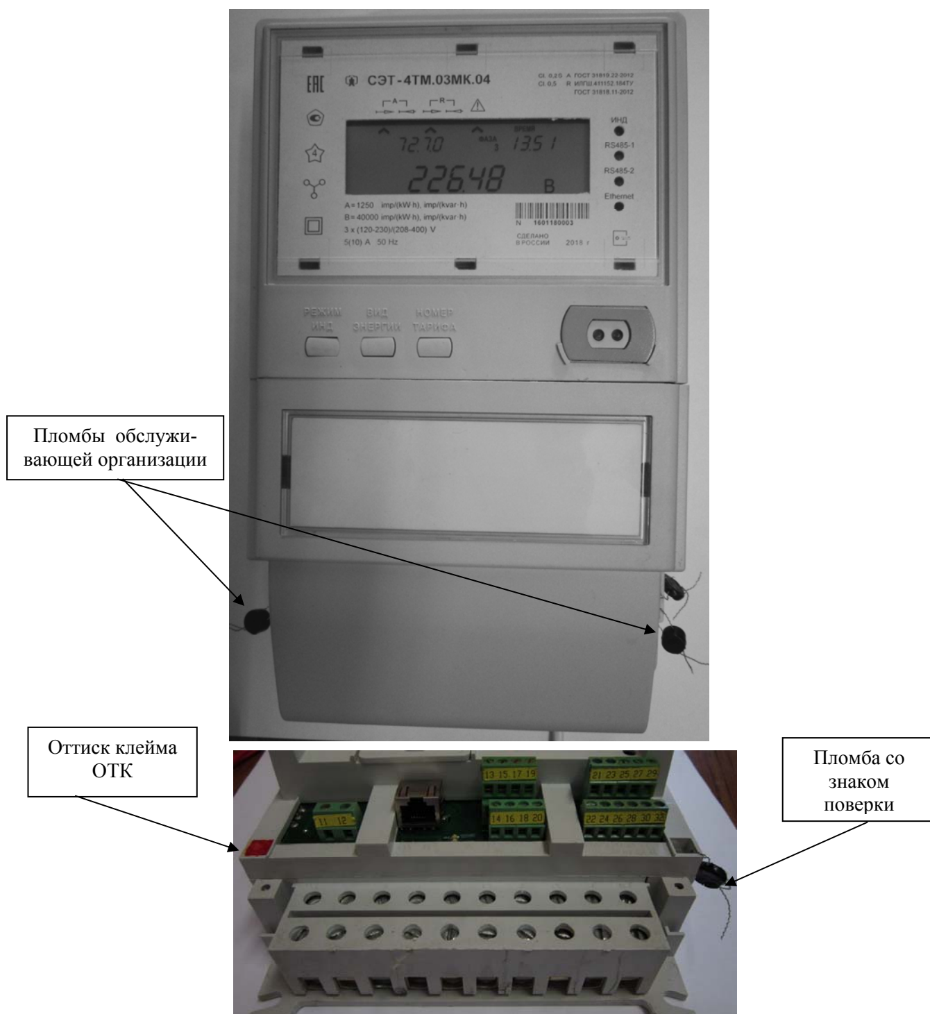
Рисунок 1 – Общий вид счетчика, схема пломбирования от несанкционированного доступа, обозначение места нанесения знака поверки
